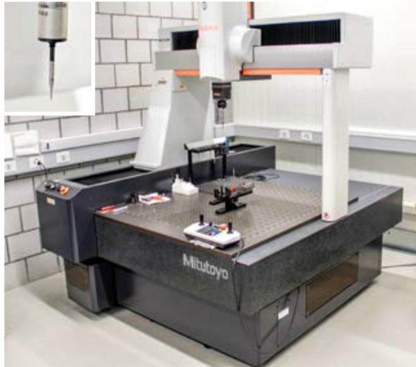
Mit dem neu angeschafften Koordinatenmessgerät lassen sich Fertigungsteile mit grosser Präzision kontrollieren. Oben links der 3D-Messkopf zum Abtasten der Objekte.
